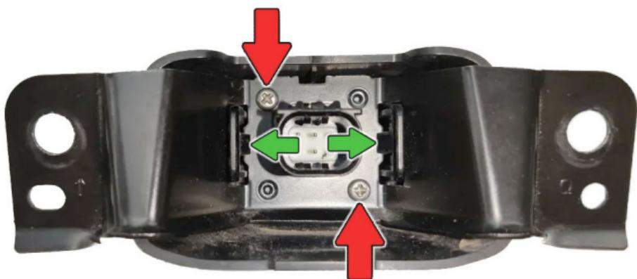
**7** Установите камеру на новый кронштейн, закрепите ее **винтами**. Установите колпачок с омывателем и закрутите **2 винта** из комплекта.
