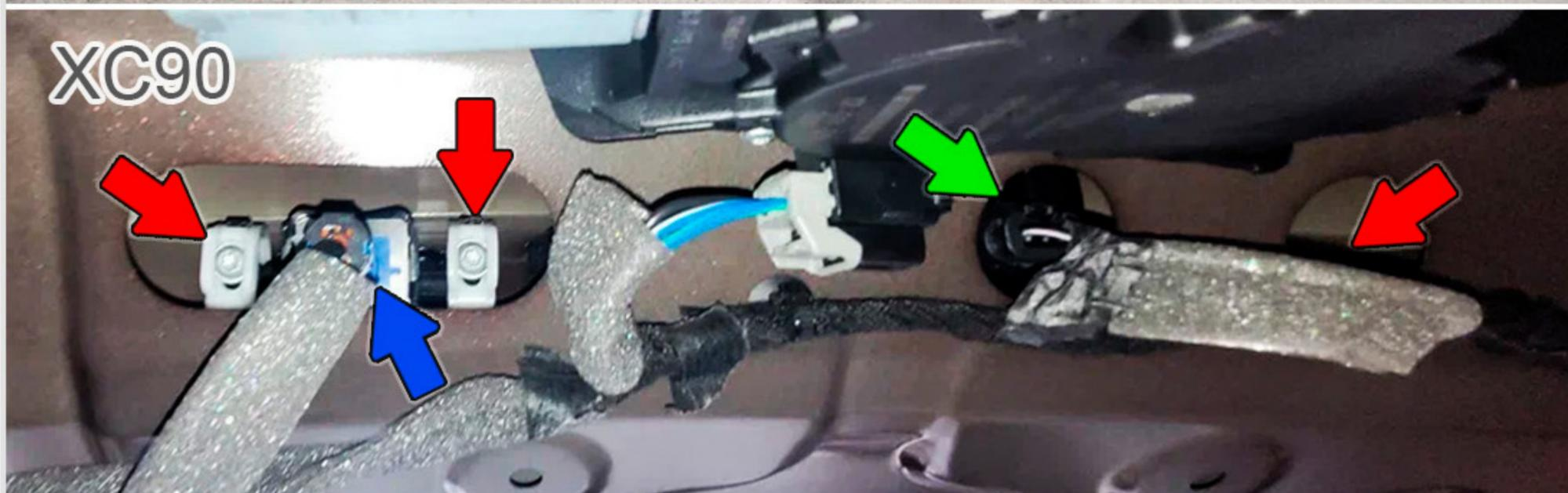
**5** Сожмите с двух сторон держатели наружной наклейки крышки багажника и снимите наклейку с камерой.
