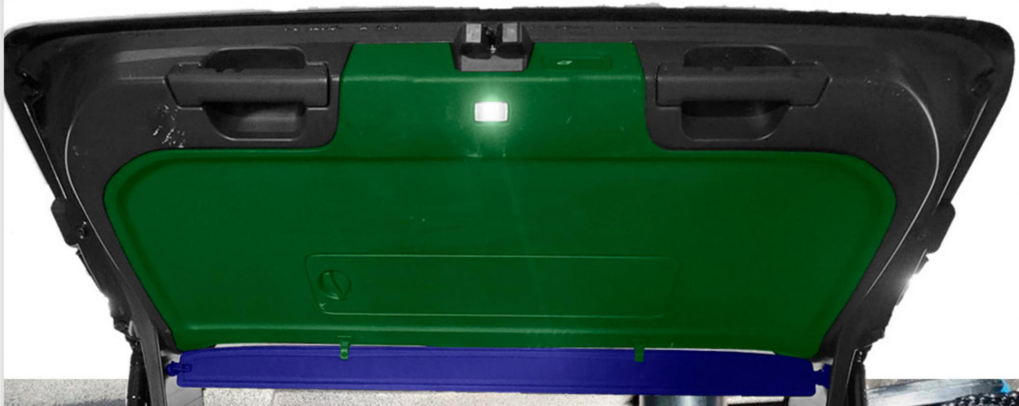
**4** Отсоедините разъемы **камеры** и **плафона** подсветки номера. Отверните на 4-5 оборотов **3 самореза** крепления наружной накладке крышки багажника.
