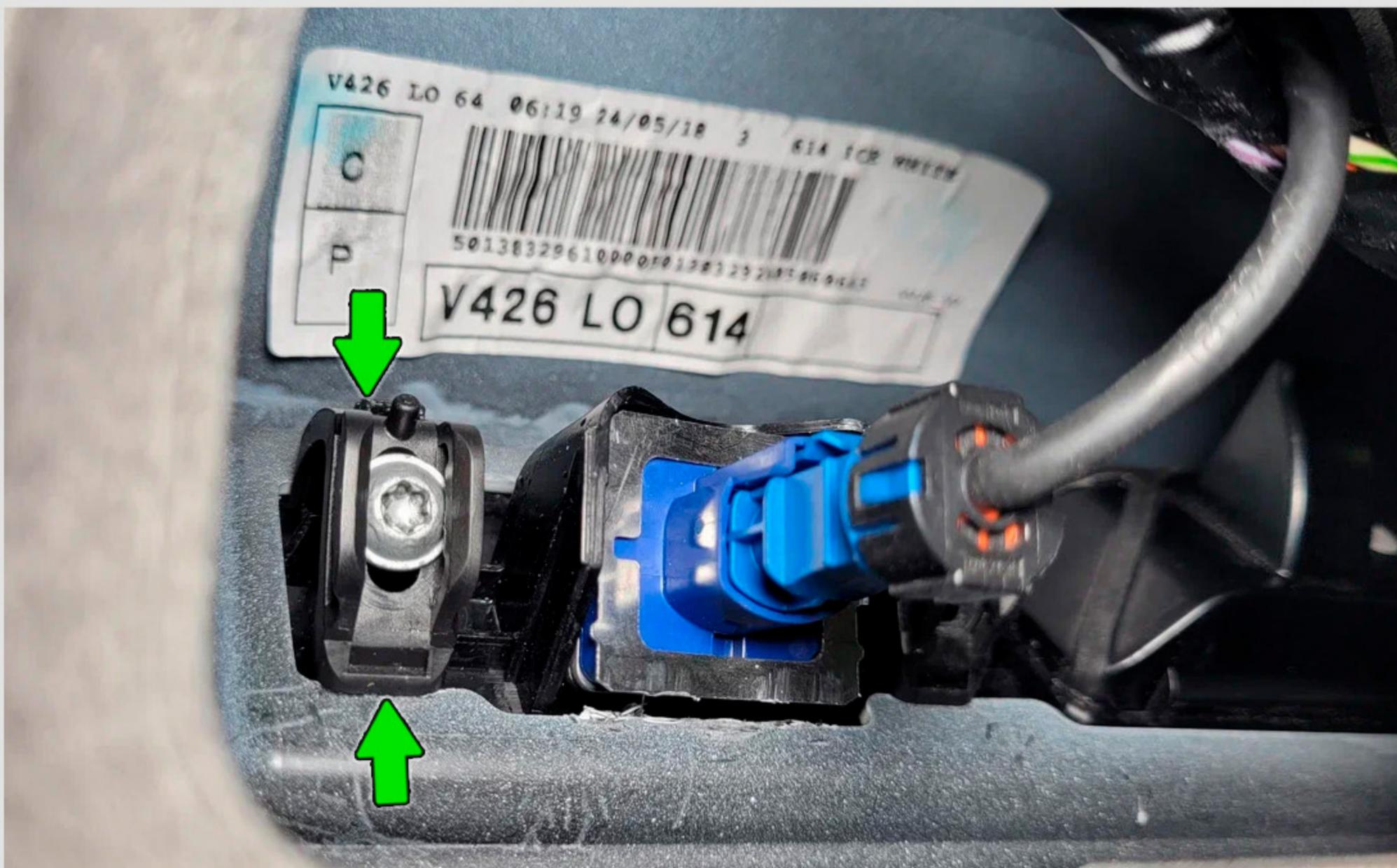
**6** Отверните и удалите винты двух креплений рядом с камерой и снимите крепления с наружной наклейки. Установите шаблон из комплекта. Как показано на фото.
