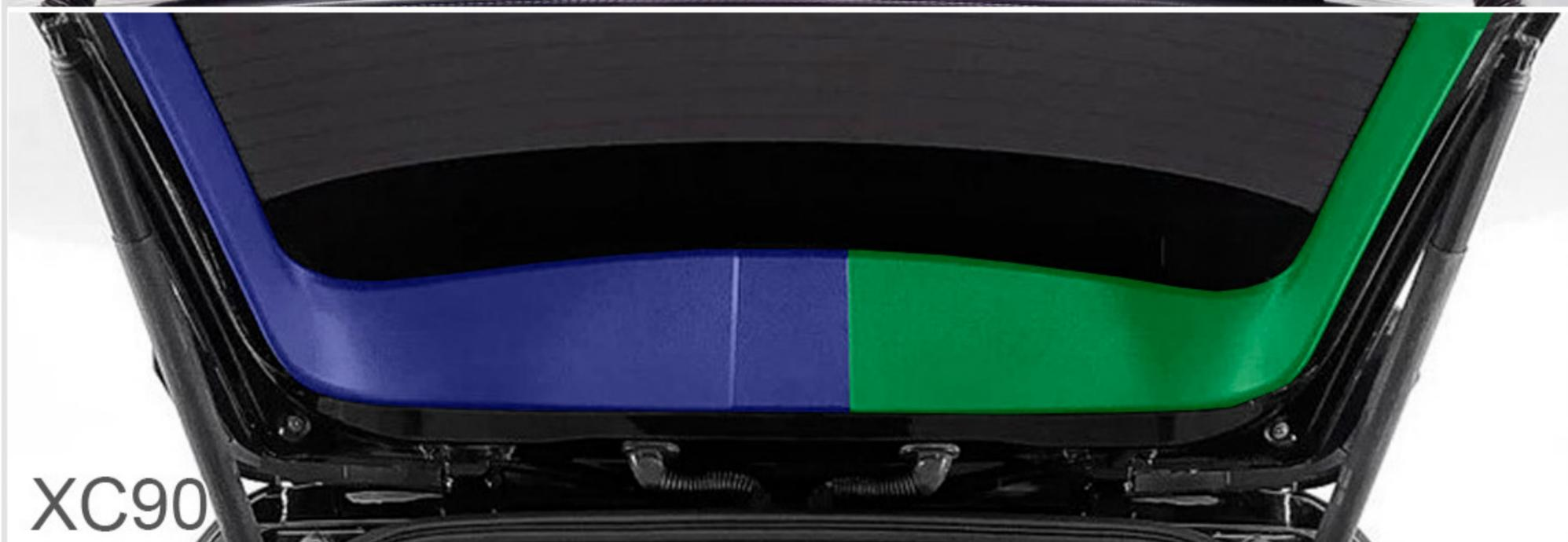
**2** Откройте крышку отсека **знака аварийной остановки** в обивке крышки багажника. Выверните **2 самореза TORX25**.
