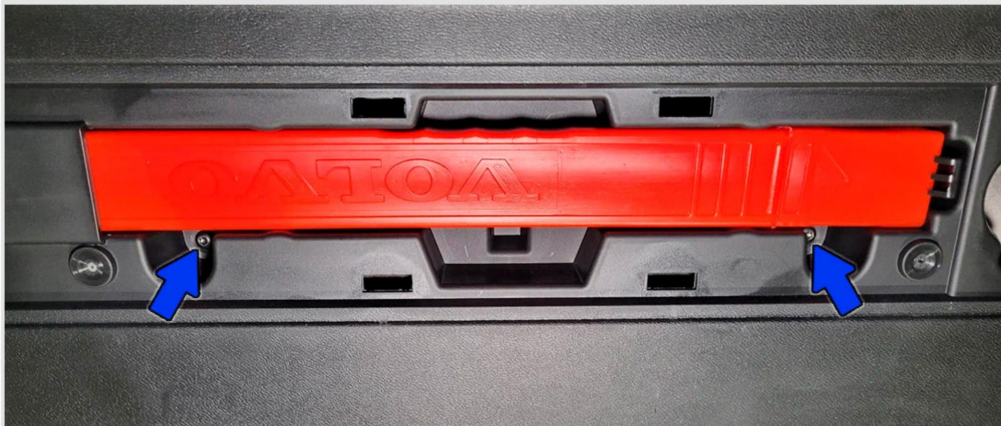
**3** Снимите **шторку** с обивки крышки багажника (для XC60), затем снимите **нижнюю облицовку** крышки багажника.
