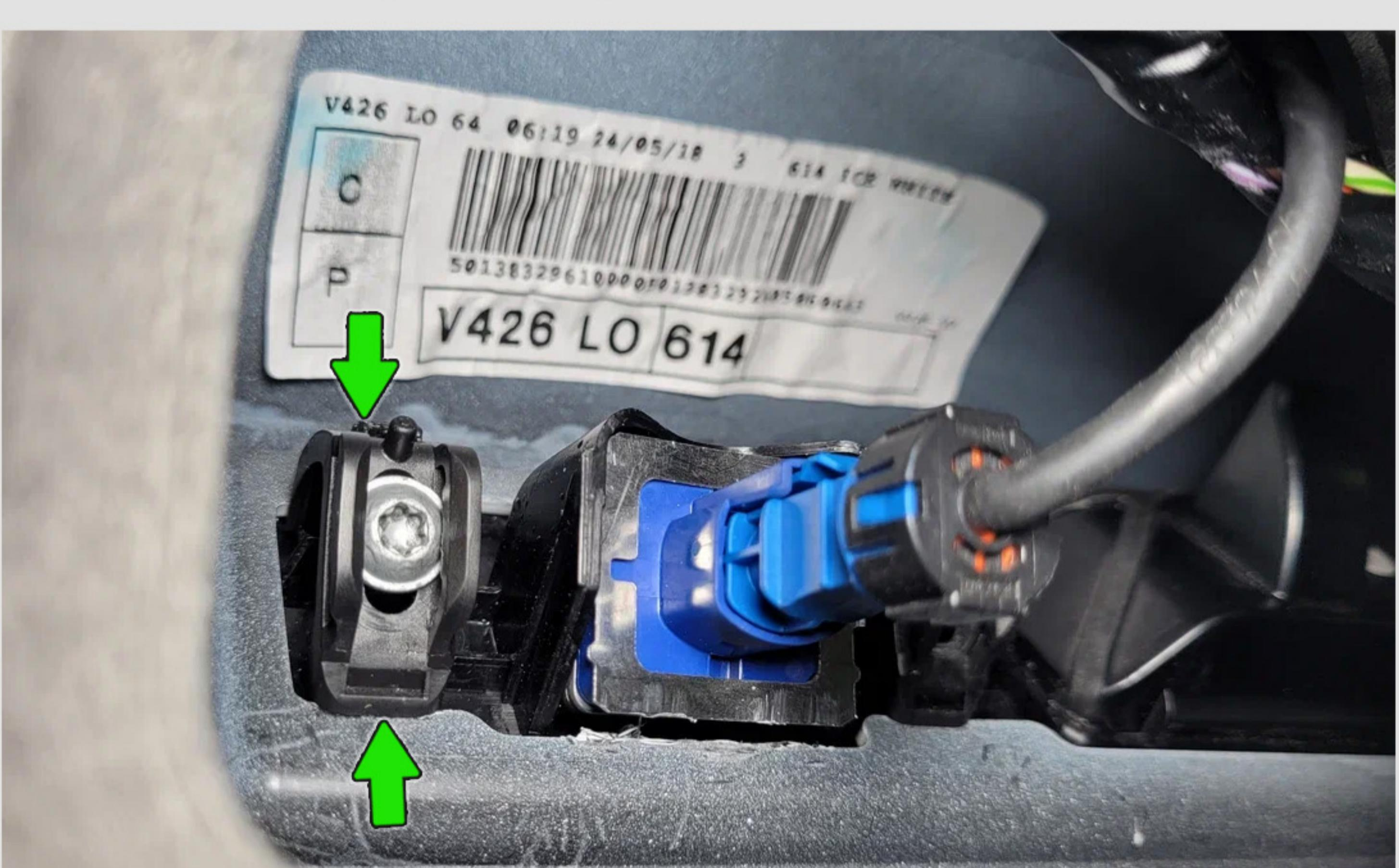
**6** Отверните и удалите **винты двух креплений** рядом с камерой и снимите крепления с наружной накладки. Установите **шаблон** из комплекта. Как показано на фото.
