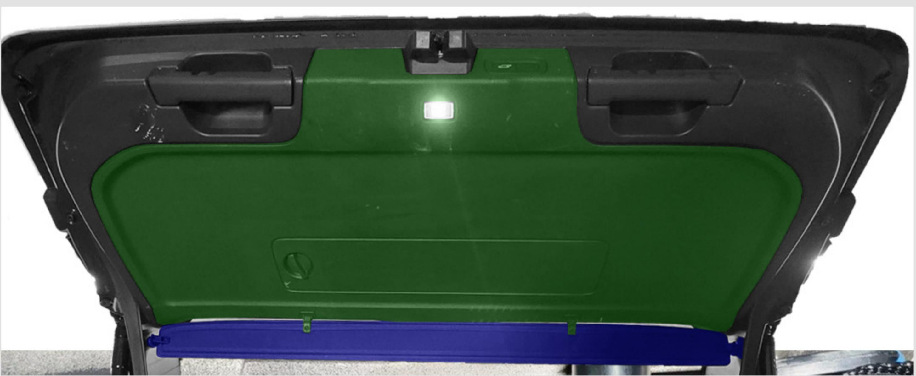
**4** Отсоедините разъемы **камеры** и **плафона** подсветки номера. Отверните на 4-5 оборотов **3 самореза** крепления наружной накладки крышки багажника.
