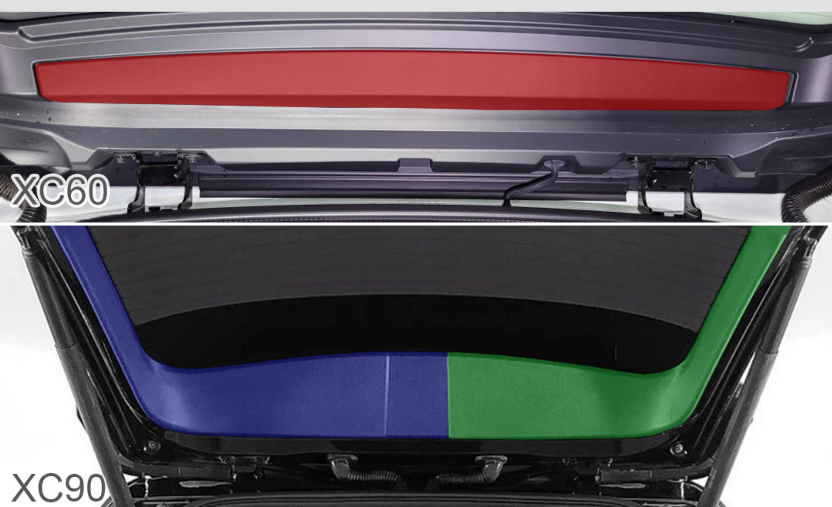
**2** Откройте крышку отсека **знака аварийной остановки** в обивке крышки багажника. Выверните **2 самореза TORX25**.
