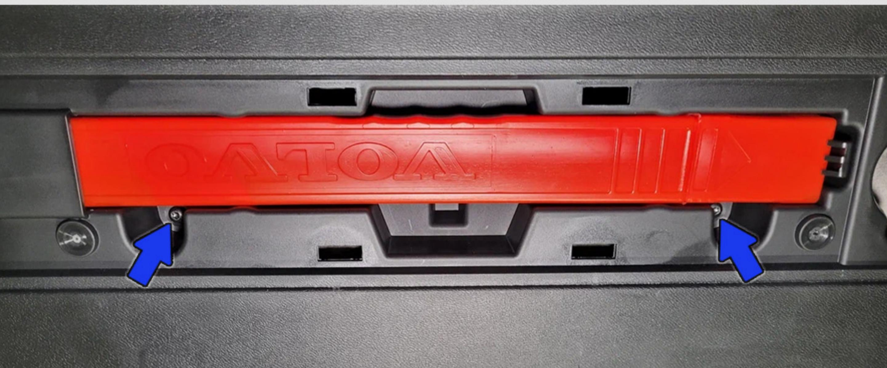
**3** Снимите **шторку** с обивки крышки багажника (для XC60), затем снимите **нижнюю облицовку** крышки багажника.
