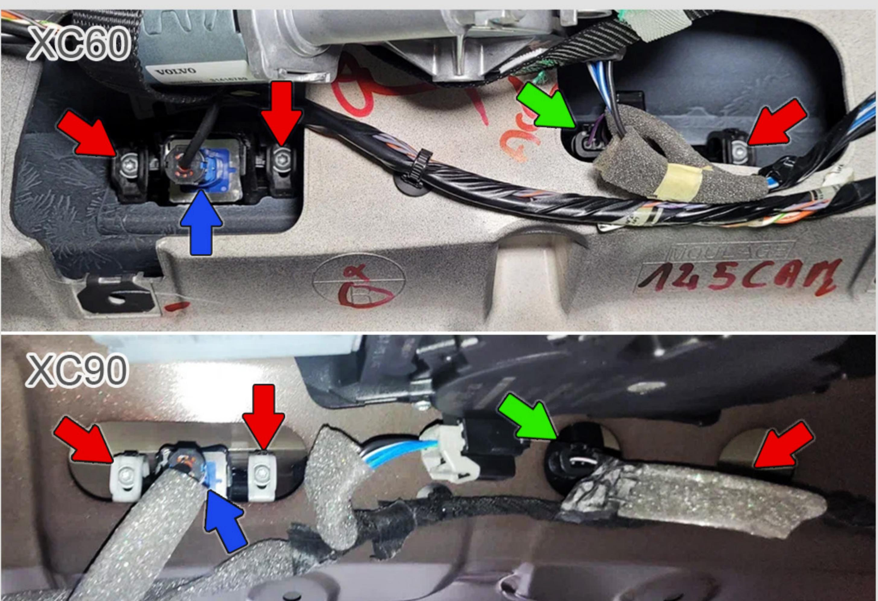
**5** Сожмите с **двух сторон** держатели наружной накладки крышки багажника и снимите накладку с камерой.
