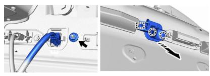
9. НАЖМИТЕ НА ФИКСАТОР РАЗЪЕМА КАК УКА-ЗАНО НИЖЕ И СНИМИТЕ РАЗЪЕМ С КАМЕРЫ
