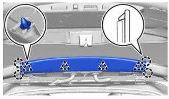
3. СНИМИТЕ ПАНЕЛЬ ОБЛИЦОВКИ ДВЕРИ БАгажного отделения
