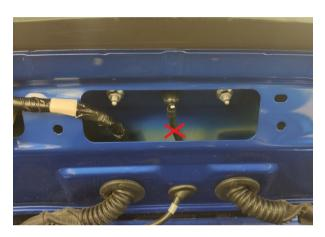
12. СОЕДИНИТЕ ТРОЙНИК С КЛАПАНОМ ШЛАНГОМ, ЗАКРЕПИТЕ ЕГО СТЯЖКАМИ НА ШТАТНОЙ ПРОВОДКЕ.
