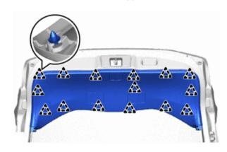
5. ВЫВЕРНИТЕ 4 БОЛТА КРЕПЛЕНИЯ НАРУЖНОЙ НАКЛАДКИ ДВЕРИ БАГАЖНОГО ОТДЕЛЕНИЯ
