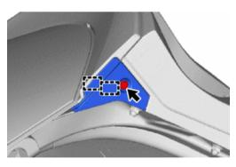
6. СНИМИТЕ НАРУЖНУЮ НАКЛАДКУ ДВЕРИ БАГАЖного отделения
