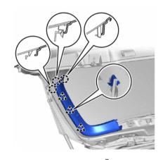
4. НА АВТОМОБИЛЯХ ПОСЛЕ РЕСТАЙЛИНГА 2019 г. СНИМИТЕ ФИКСАТОРЫ И БОКОВЫЕ КРЫШКИ ЛЕВОГО ПРАВОГО ФОНАРЕЙ КРЫШКИ БАГАЖНИКА
