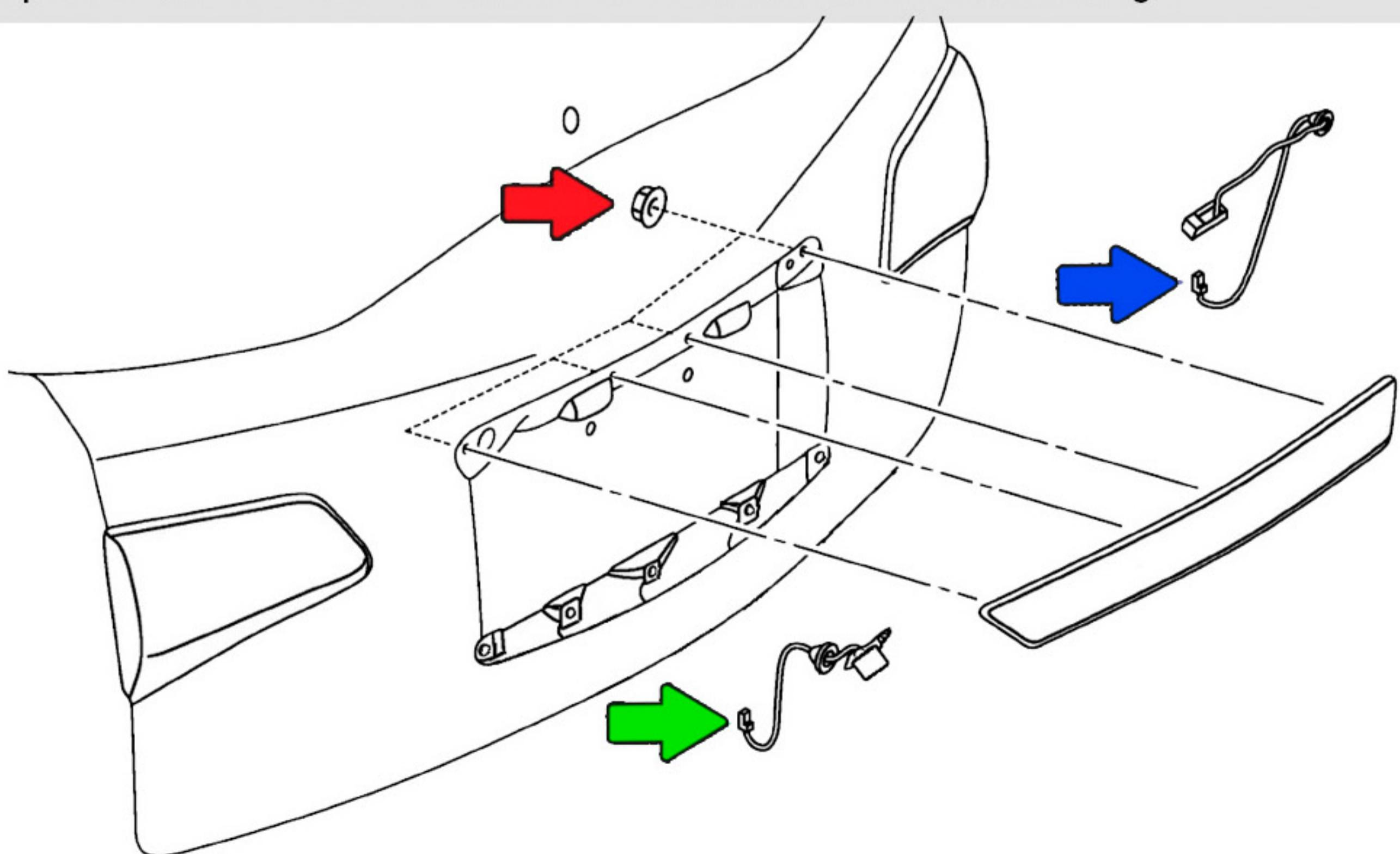
**5** Открутите **винты** крепления штатного кронштейна к наружной планке. Открутите **винты** крепления провода к камере и снимите его. Открутите **винты** крепления камеры к кронштейну.
