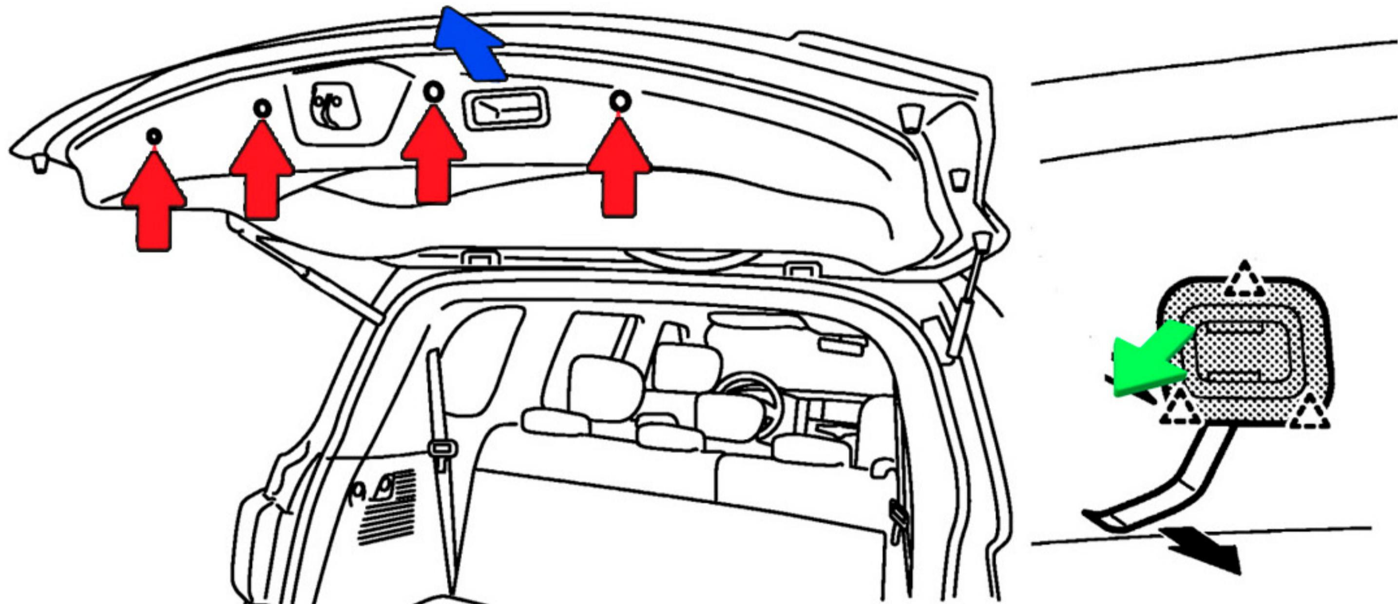
**2** Снимите центральную облицовку крышки багажного отделения.
