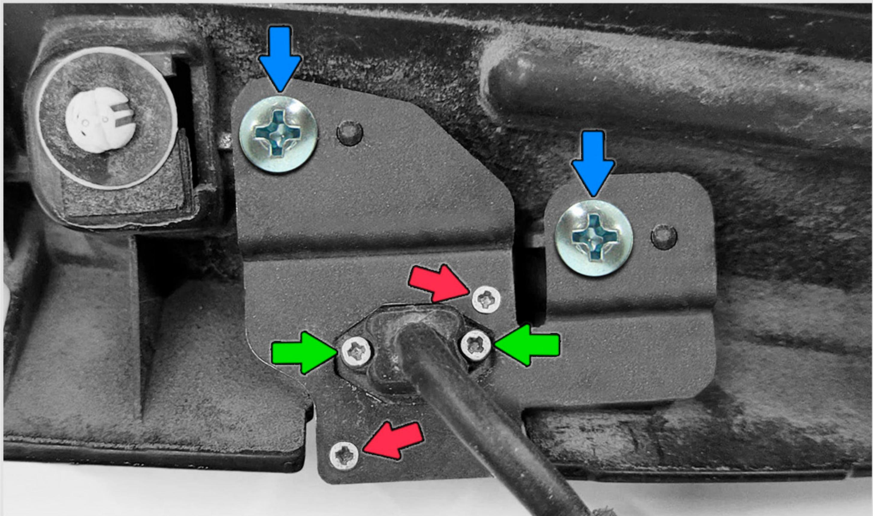
**6** Установите камеру на новый кронштейн. Закрутите **винты** крепления. Присоедините провод и закрутите **винты** его крепления.
