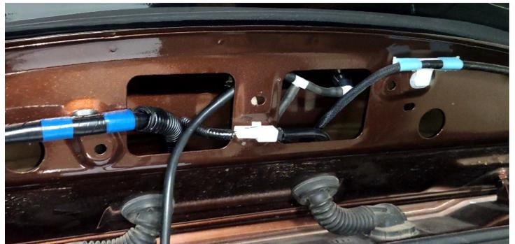
12. ВКЛЮЧИТЕ ОМЫВАТЕЛЬ ЗАДНЕГО СТЕКЛА, УБЕДИТЕСЬ В ОТСУТСТВИИ ТЕЧЕЙ. СБОРКА АВТО ОСУЩЕСТВЛЯЕТСЯ В ОБРАТНОЙ ПОСЛЕДОВАТЕЛЬНОСТИ (ПРИ СБОРКЕ УБЕДИТЕСЬ ЧТО УСТАНОВЛИВАЕМЫЕ НАКЛАДКИ НЕ ПЕРЕЖИМАЮТ ШЛАНГ ПОДАЧИ ЖИДКОСТИ К ОМЫВАТЕЛЮ КАМЕРЫ). ПРИ НЕОБХОДИМОСТИ ОТРЕГУЛИРУЙТЕ ПОЛОЖЕНИЕ ШАРИКА ДЛЯ НАИЛУЧШЕГО ОМЫВАНИЯ КАМЕРЫ
