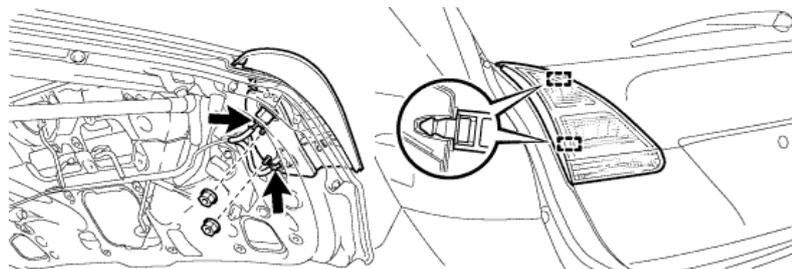
6. ОТВЕРНИТЕ 5 ГАЕК КРЕПЛЕНИЯ НАРУЖНОЙ НАКЛАДКИ КРЫШКИ БАГАЖНИКА (ДЛЯ ДОСТУПА К ВЕРХНЕЙ ГАЙКЕ ОТОДВИНЬТЕ В СТОРОНУ МОТОРА СТЕКЛООЧИСТИТЕЛЯ)
