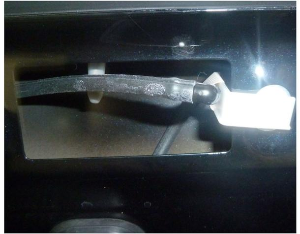
9. СОЕДИНИТЕ ТРОЙНИК С КЛАПАНОМ ШЛАНГОМ, ЗАКРЕПИТЕ ЕГО СТЯЖКАМИ НА ШТАТНОЙ ПРОВОДКЕ.
