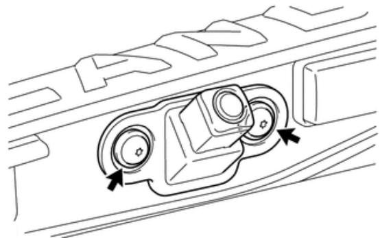
5. СОЖМИТЕ УСИКИ ПЛАСТИКОВЫХ КЛИПС, ЛИБО ОТРЕЖЬТЕ КЛИПСЫ И СНИМИТЕ КАМЕРУ
