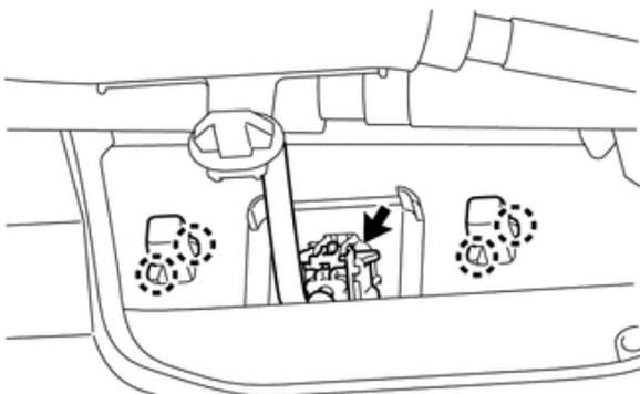
6. НАЖМИТЕ НА ФИКСАТОР РАЗЪЕМА КАК УКАЗАНО НИЖЕ И СНИМИТЕ РАЗЪЕМ С КАМЕРЫ
